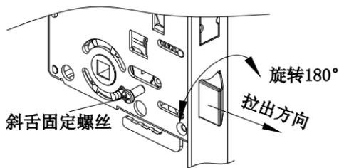
(2) 如图：安装锁芯前，需用工具调整好锁芯孔位置，方便安装前/后锁体。
