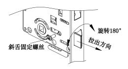
② 如图:安装锁芯前,需用工具调整好锁芯孔位置,方便安装前/后锁体。
