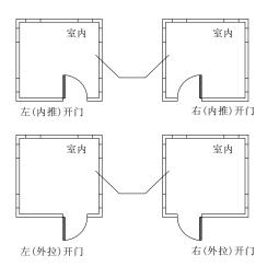
左开门:您站在门的外侧,当门的固定铰链在左边时,指纹锁定义为左 开门,分左内推开门和左外拉开门。
