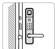
关门时，如果斜舌没有完全弹出（即门未关好），此时门锁会发出报警提示音。
