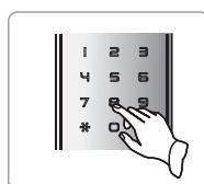
连续3次输入错误密码，键盘将自动锁定，按任意数字键都会提示“键盘已锁”，约15分钟后自动解锁。连续输入错误密码未达3次，20秒后自动清除错误次数。
