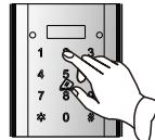
△ 用户在门锁安装调试完成后，若没有修改初始管理密码00123456，滑盖唤醒将提示“请修改出厂管理密码”。
